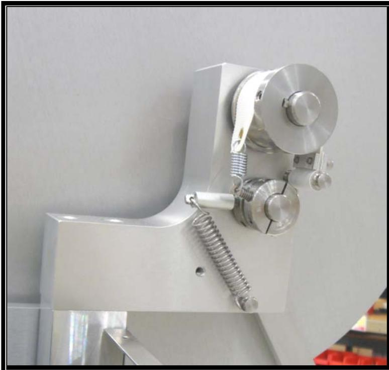
Figure 18 BRAKE ASY UNWIND
